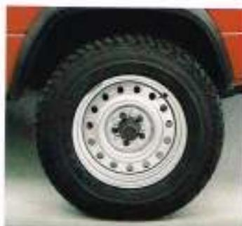
Für besonders hohe Anforderungen bei Einsatz in überwiegend tiefem Gelände gibt es den syncro auch in einer 16" Version. Mit größerer Bodenfreiheit und speziellen Verstärkungsmaßnahmen im Federungs- und Karosseriebereich.
