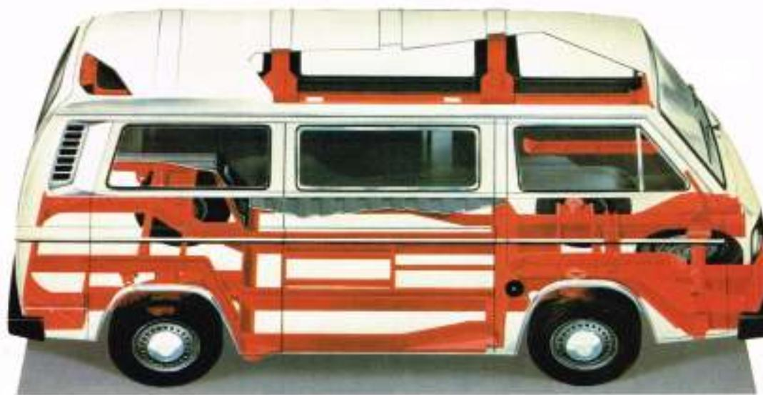
Zum aufwendigen Sicherheitssystem gehört die verformungssteife Rahmenkonstruktion der Bodengruppe ebenso wie der Gabelrahmen aus widerstandsfähigen Rahmenprofilen unter dem Fahrerhaus. Sie bewirken eine hohe passive Sicherheit. Aufprallenergie wird über
