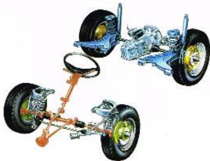
Ein weiteres Beispiel für den technischen Vorsprung der Transporter- und Bus-Modelle ist die vorderrichtige Doppelquerlenker-Vorderrachse mit spurstabilisierendem Lenkrollradius. Sie verhindert weitgehend ein Ausbrechen beim Bremsen
